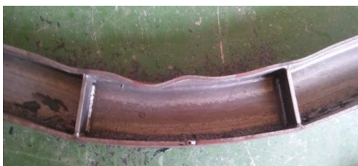
図 16 実験における H 型鋼の破壊形状
